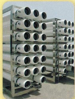
Tubos de Presión
